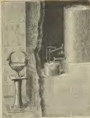
Fig. 1.—Vasija maravillosa de Heron de Alejandría. Esta vasija no se vacía, cualquiera que sea la cantidad de líquido que se saque de ella.
